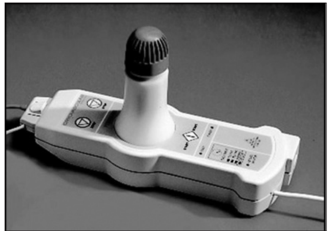
Figura 2. Unidade de insuflação com microprocessador e cilindro de óxido nítrico.
